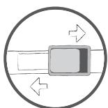
Cinturino di ritenzione con sistema di chiusura micrometrico
